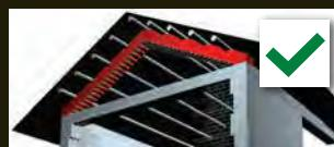
**如要用砖砌做山墙，一定要用钢筋混凝土做卧梁(爬山梁)把砖箍起。**
