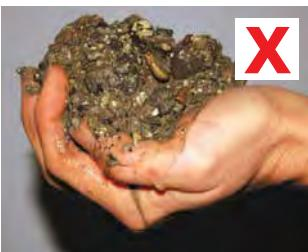
拌和的混凝土, 石子的表面不应外露。
