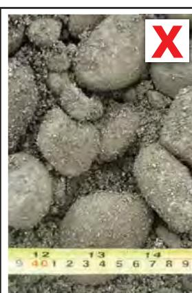
配置混凝土时不能使用连沙石。
