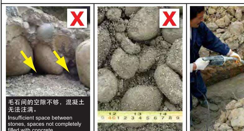
毛石间的空隙不够,混凝土无法注满。
